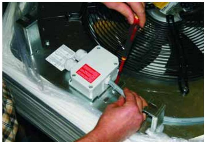
6: Lösen Sie die Befestigungsschrauben des Klemmenkastens.
