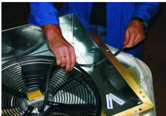
5: Ziehen Sie das Kabel durch die Kabeldurchführung.
