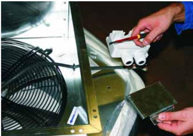
**7:** Demontierte Grundplatte des Klemmenkastens
