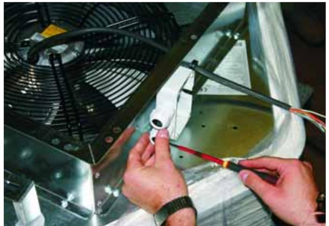
**8:** Montieren Sie den Klemmenkasten indem Sie ihn in den vorgebohrten Löchern des Anschlussrahmens festschrauben.
