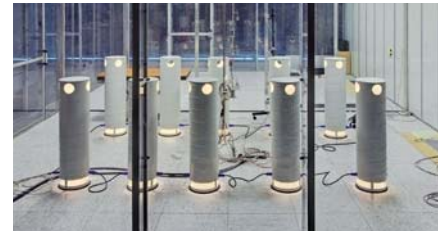
Testaufbau von 10 leistungsgeregelten Dummies
